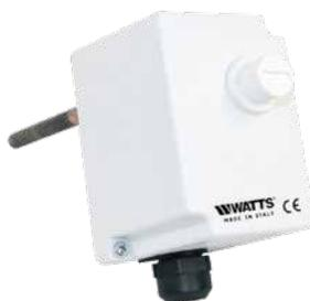
Termostato di blocco ad immersione a sicurezza positiva e riarmo manuale, con taratura fissa. Interrompe l'apporto di calore quando la temperatura dell'acqua raggiunge il valore di taratura prefissato. Temperatura di taratura 97°C (tolleranza +3÷-5°C). Bulbo sensibile con guaina da 1/2" M di lunghezza 89,7 mm. Portata contatti: 16(5)A 250V. Terminali faston 6,3 mm con morsetto a vite.
