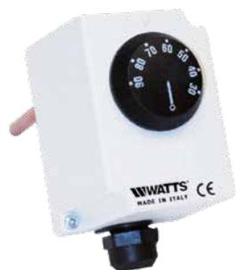
Termostato di regolazione ad immersione a 3 contatti in commutazione. Interrompe l'apporto di calore quando la temperatura dell'acqua raggiunge il valore di taratura prefissato regolabile 30÷90°C. Bulbo sensibile con guaina da 1/2" M di lunghezza 100 mm. Custodia in resina con manopola di regolazione esterna. Grado di protezione: IP40. Tolleranza: ±3°C. Portata contatti: 16(5)A 250V. 400V 10(1)A.
